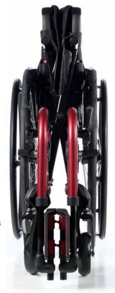
**Ovale Rohre** sind biegesteifer als Rundrohre- dieses physikalische Prinzip machen wir uns schon mit unseren Premium-Produkten Nitrum und Xenon² zunutze, und verwenden es jetzt auch am QS5 X bei den Kreuzstrebenrohrern. Damit wird die Kreuzstrebe nicht nur steifer, was das Fahrverhalten positiv beeinflusst, sondern auch noch leichter.
