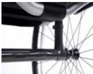
// NTR010403 Achsbaugruppe superlight, Carbon
