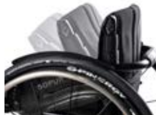
// NTR030158 Aluminiumrücken, Faltmechanismus: Drehgriff
