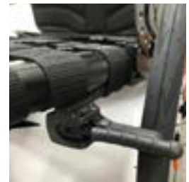
// NTR060024 Kompaktbremse EVO, Leichtgewicht
