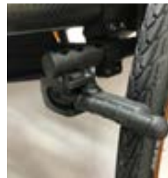
// NTR060023 Kompaktbremse EVO
