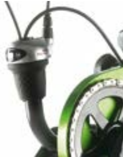
// ATT070043 Drehgriffschalter am Rahmen montiert
